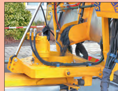
Het asfalt loopt vanuit de kipper, of hier containerbak, via een aandrijving in de spreiderarm.
